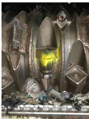
Zona del rotore individuata in cui è necessario il riporto di saldatura
