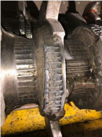
Ispezione di un particolare del rotore trituratore primario con ripristino materiale antiusura
