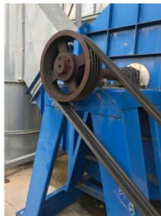
Ispezione cinghie di trasmissione ventilatori filtro a maniche
