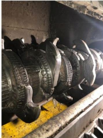
Ispezione rotore trituratore primario con ripristino materiale antiusura
